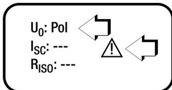
⇨ Correggere la polarità sul modulo solare e riavviare la misura.
