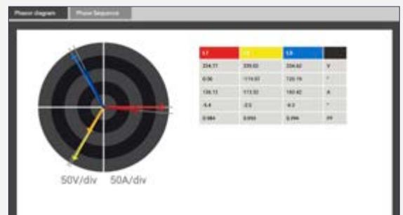
Diagramma vettoriale per il controllo dei collegamenti
