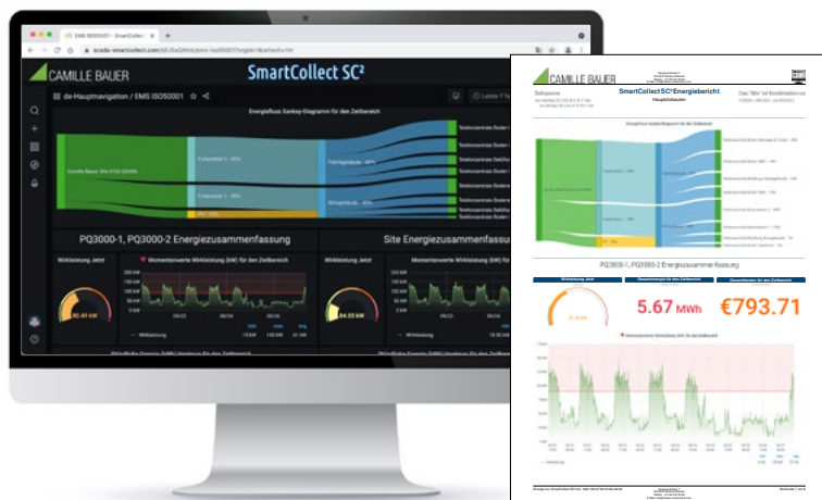
Display con diagramma di Sankey e grafico della potenza attiva
