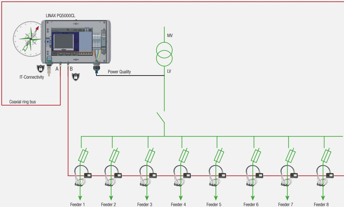
*Variante 1: custodia da campo per montaggio a parete (con alimentazione integrata per i moduli Current Link)*
