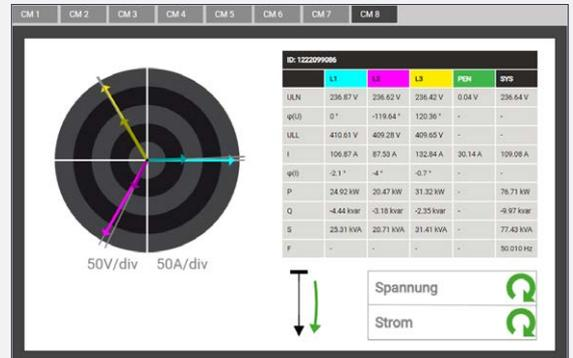
Diagramma vettoriale per il controllo dei collegamenti
