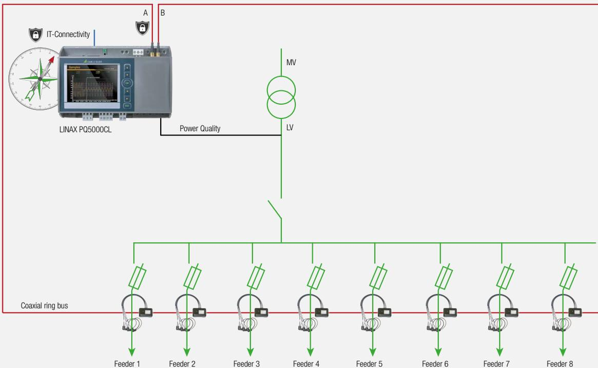
*Variante 2: montaggio su guida top-hat (è necessario un alimentatore separato per i moduli Current Link)*
