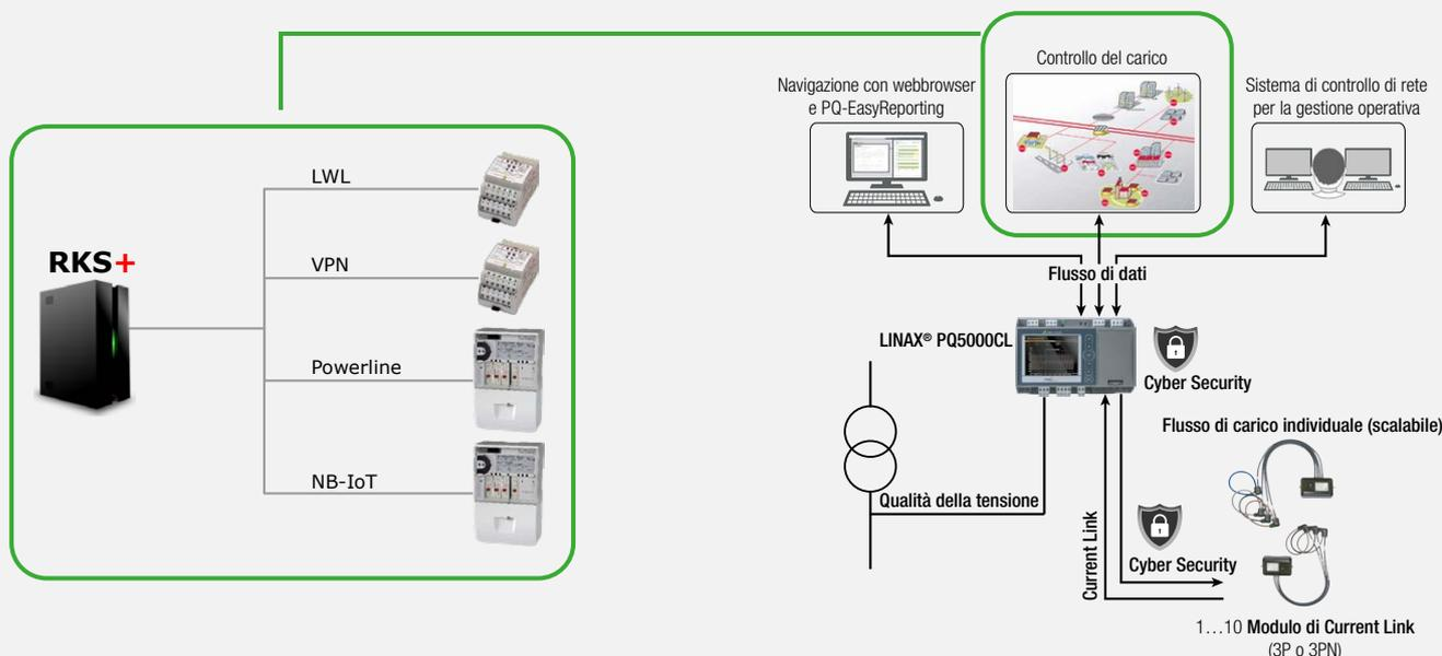
L'accuratezza e la versatilità dei dispositivi di misura Camille Bauer ampliano il sistema di gestione del carico RKS in un sistema intelligente di controllo della griglia fine. In caso di condizioni critiche della rete, i dispositivi di
