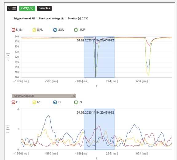
Registrazione degli eventi PQ con opzione di zoom
