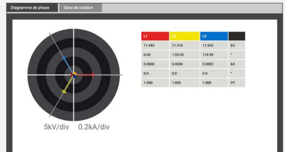
Diagramme vectoriel pour le contrôle de la connexion
