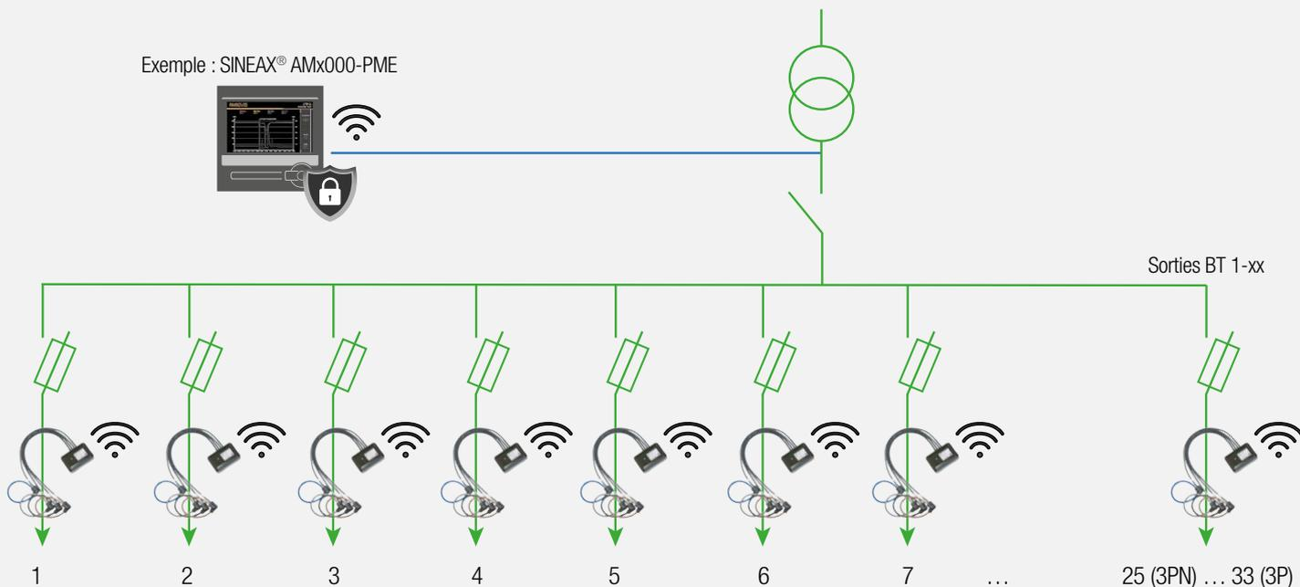
Station de base avec la série SINEAX® AM, SINEAX® DM5000, LINAX® PQ ou CENTRAX® CU, y compris la centrale Power Monitoring Energy (PME) intégrée et les capteurs PME pour la saisie de 100 courants max. via signal radio.
