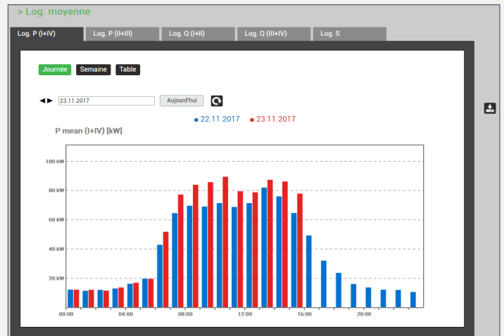
Profil de la charge quotidienne actuelle avec les valeurs de la veille via le site web de l'appareil
