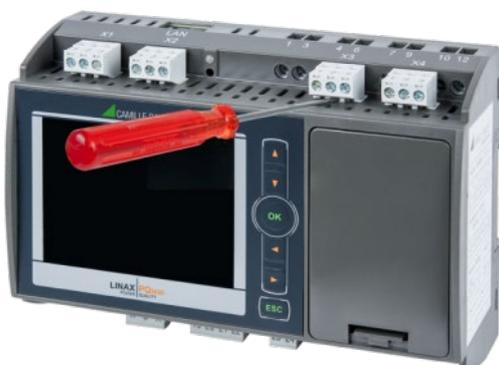
Afin d'accéder aux bornes à vis des entrées de courant, il faut, le cas échéant, retirer préalablement les bornes à fiche situées au-dessus.
