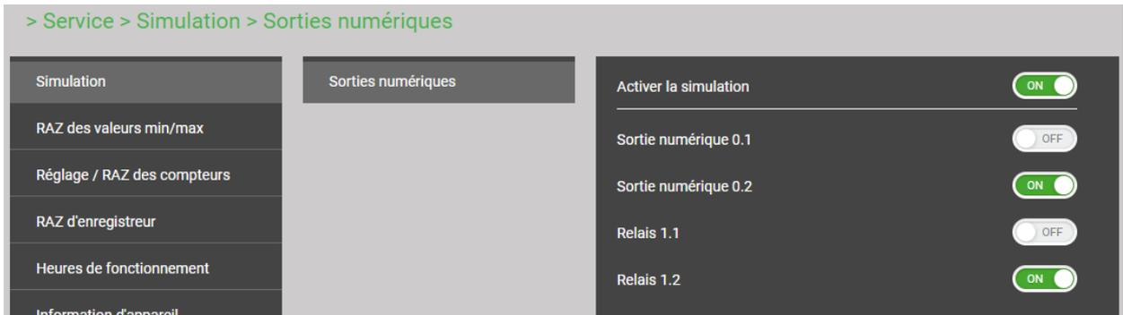
Simulation des sorties numériques via l'interface web de l'appareil
