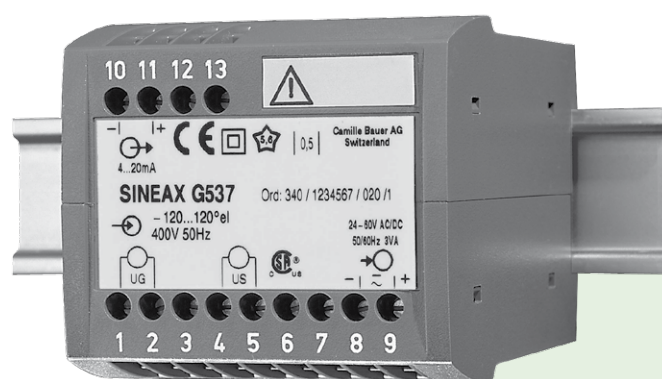
Fig. 1. Convertisseur de mesure SINEAX G537 en boîtier P13/70 encliqueté sur rail «à chapeau».
