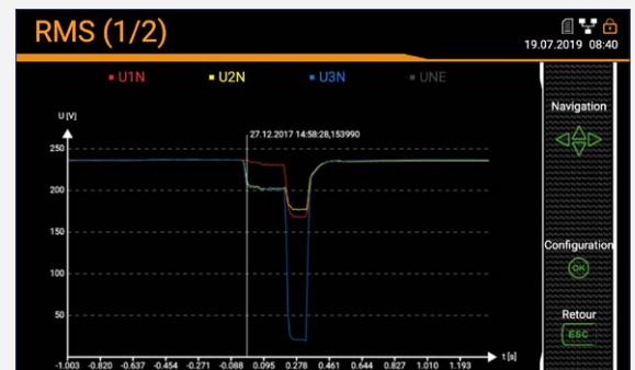
Affichage d'un creux de tension sur écran local
