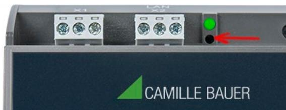
Die versenkte Reset-Taste (unterhalb der Betriebs-LED) für mindestens 3s drücken. Während dem Reset blinkt die Betriebs-LED rot.
