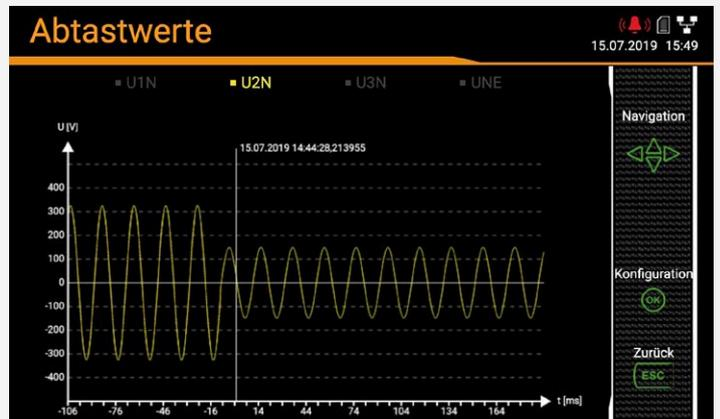
Anzeige Spannungseinbruch auf lokalem Display
