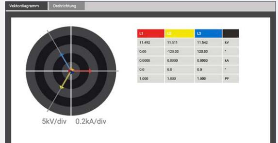
Vektordiagramm zur Anschlusskontrolle
