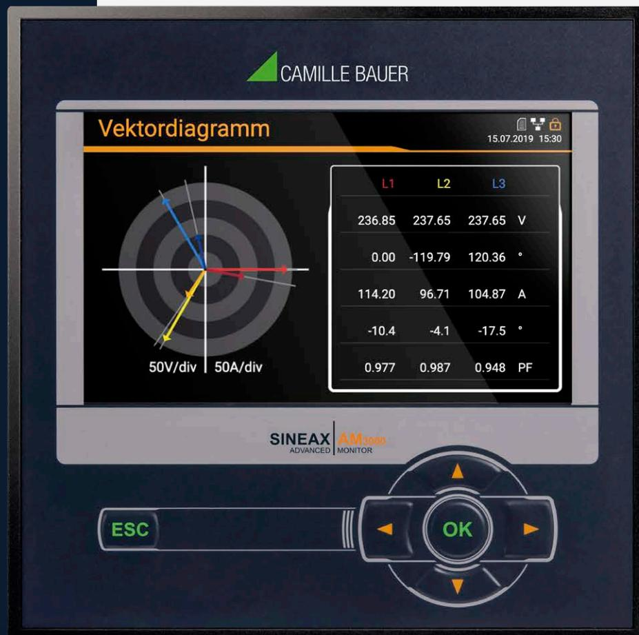
Die Geräte der SINEAX AM-Reihe sind Kompaktgeräte für die Messung und Überwachung in Starkstrom-Netzen. Sie bestechen durch die Qualität der Anzeige und durch intuitive Bedienung. Die Geräte stellen eine breite Funktionalität zur Verfügung, welche sich mit optionalen Komponenten noch weiter ausbauen lässt. Die Anbindung des Prozess-Umfelds kann mit Hilfe von Kommunikations-Schnittstellen, über digitale I/Os, Analogausgänge oder Relais vorgenommen werden.
