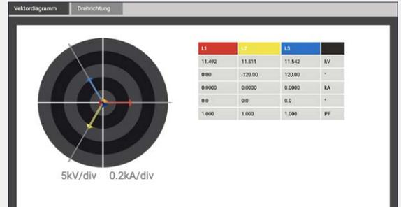
Vektordiagramm zur Anschlusskontrolle
