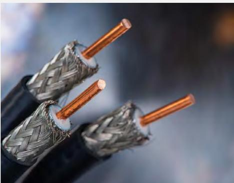
hohlzylindrischen Aussenleiter umgeben ist. Der Aussenleiter schirmt den Innenleiter vor Störstrahlung ab. Koaxialleitungen sind dazu geeignet, im Frequenzbereich von einigen kHz bis zu einigen GHz hochfrequente, breitbandige Signale zu übertragen.
