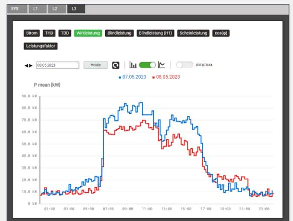
Tages-Lastgang mit Vortageswerten für einen PME-Sensor via Webseite des Basisgerätes
