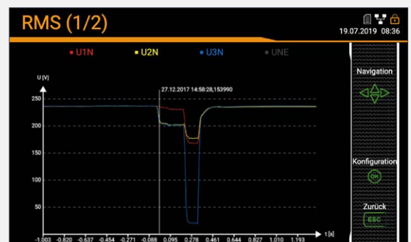
Anzeige Spannungseinbruch auf lokalem Display
