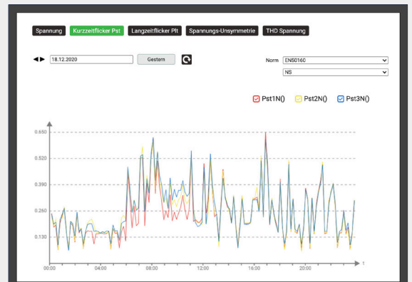
Tagesverlauf des Kurzzeitflickers Pst via Webseite des Gerätes
