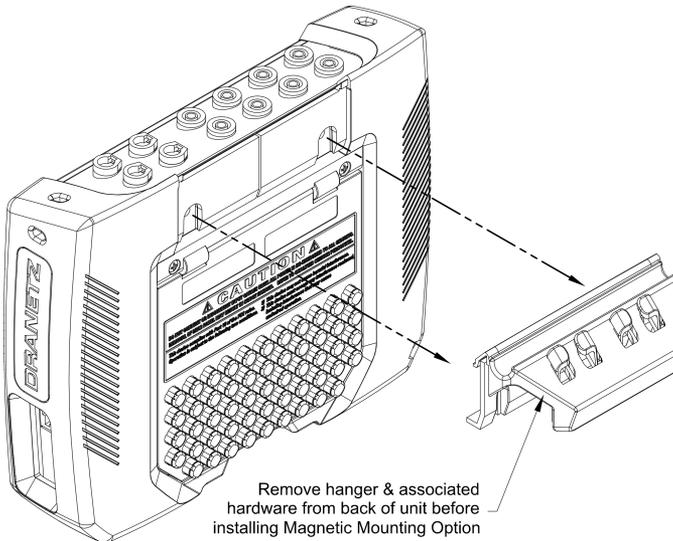
2. Befestigen Sie die Magnetbaugruppe mit den beiden "A"-Kreuzschlitzschrauben (P/N 113200-G15, #6-32 x 5/8 Zoll), die an der Magnetbaugruppe angebracht sind, am Gerät.
