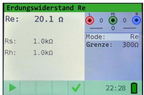
Abb. 7: Erdwiderstandsmessung, Kabelanschluss und Ergebnisse
