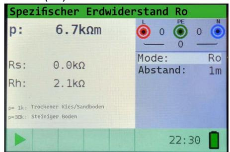
Abb. 8: Messung des spezifischen Erdwiderstands Ro, Kabelanschluss und Ergebnisse
