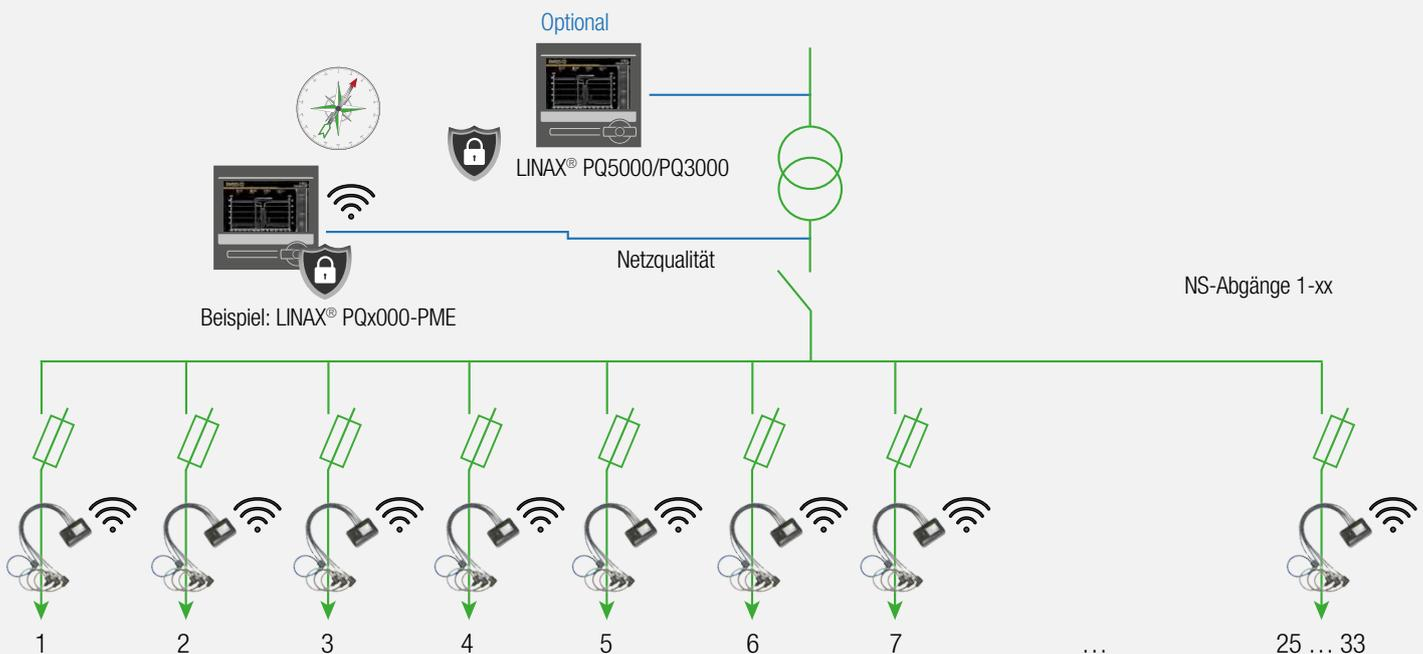
Basisstation mit der Serie SINEAX® AM, SINEAX® DM, LINAX® PQ oder CENTRAX® CU, inkl. integriertem Power Monitoring Energy Modul (PME) und PME-Sensoren zur Erfassung von max. 100 Strömen via Funksignal.
