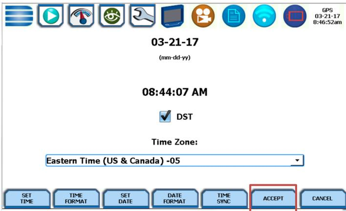
In der oberen rechten Ecke über dem Datum und der Uhrzeit sollte nun "GPS" angezeigt werden, was bedeutet, dass das GPS korrekt funktioniert.
