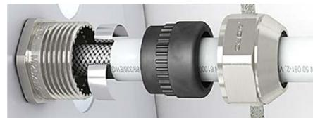
Kontaktfeder mit Dichtungssatz in Unterteil schieben und Druckmutter mit Werkzeug anziehen. Bitte darauf achten, dass die Kontaktfeder den Schirm kontaktiert.
