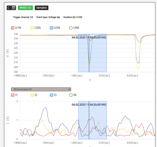
PQ-Ereignisaufzeichnung eines PQ5000MOBCLM mit Zoom-Möglichkeit
