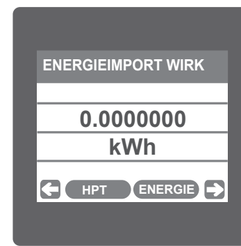
UNTERMENÜ 5: ENERGIE Anzeige 33: Wirkenergie Import
