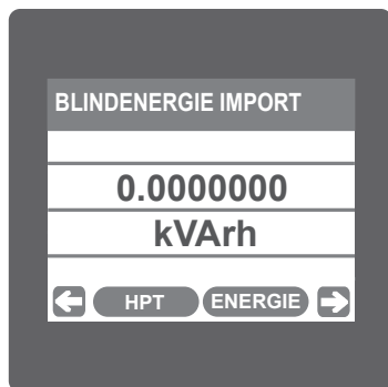
Anzeige 35: Blindenergie Import
