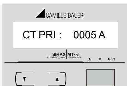
Mit der "AB" Taste gelangen Sie in den Modus "Stromwandler-Primärwert editieren". Dies scrollt den Wert der höchstwertigen Stelle von 0 bis 9, es sei denn, der gegenwärtig angezeigte Stromwandler-Primärwert ergibt zusammen mit dem Spannungswandler-Primärwert eine maximale Systemleistung von mehr als 666MVA. In diesem Fall ist der Bereich der Stelle begrenzt. Der Wert springt um.
