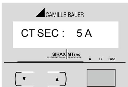
In dieser Anzeige stellen Sie den Sekundärwert für den Stromwandler ein. Mit der "AUF" Taste akzeptieren Sie den aktuellen Wert und gelangen zum Menü Energieanzeige auf Modbus. (Abschnitt 7.2.5).
