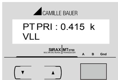
Mit der "AUF" Taste akzeptieren Sie den aktuellen Wert und gelangen zum Menü Stromwandler (CT) Primärwert editieren. (Abschnitt 7.2.3). Mit der "AB" Taste gelangen Sie in den Modus "Spannungswandler-Primärwert editieren".
