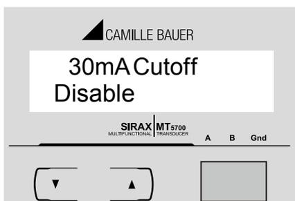
In dieser Anzeige kann der Benutzer den Anlaufstrom auf 30mA einstellen. Mit der "AB" Taste gelangt man in den Editiermodus und kann zwischen Enable und Disable (Aktivieren und Deaktivieren) hin- und herschalten.
