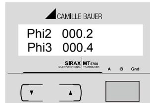
Anzeige 27: Phasenwinkel Phase 2, 3 (Phi 2, Phi 3)
