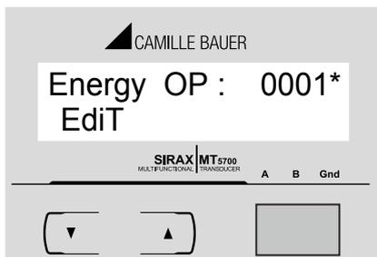
Mit der " AUF " Taste akzeptieren Sie den aktuellen Wert und gelangen zum Menü "Parameter zurücksetzen" (siehe Abschnitt 7.2.6).
