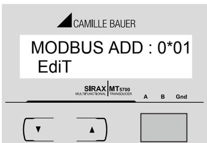
Mit diesem kann der Benutzer eine Geräteadresse für die Kommunikation über RS 485 einstellen. Der zulässige Bereich für die Adresse ist 1 bis 247. Mit der "AB" Taste gelangen Sie in die Editierung der Modbusadresse.
