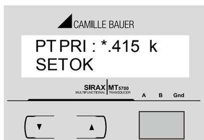
Soll die Skalierung berichtigt werden, kehren Sie mit der "AB" Taste zum Modus "Spannungswandler-Primärwert editieren" zurück. Die Stellen blinken, um anzuzeigen, dass der Multiplikator (Dezimalpunktposition) gewählt werden muss.
