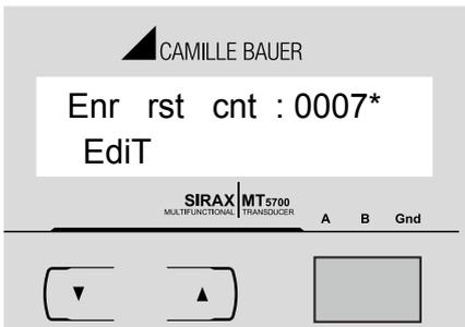
Diese Anzeige ermöglicht Benutzern, die maximale Anzahl Stellen einzustellen, nach der sich der Energiewert auf null stellt.
