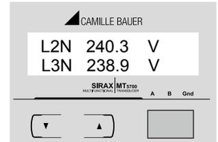
Anzeige 4: Leiter-zu-Nullleiter-Spannungen (U2N, U3N) (nur für 4-Draht)
