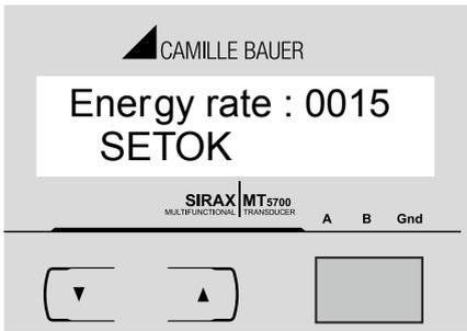
Mit der "AB" Taste gelangen Sie erneut in den Editiermodus für die Energieabtastrate.
