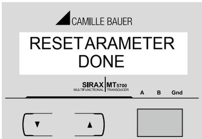
Soll ein weiterer Parameter zurückgesetzt werden, drücken Sie die "AB" Taste und scrollen Sie erneut zum Parameter. Nachdem die DONE-Anzeige erscheint gelangen Sie mit der "AUF" Taste ins Menü Modbusadresse. (Abschnitt 7.2.7)
