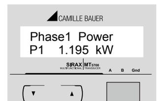
Anzeige 20: Phase 1 Wirkleistung (P1) (nur für 4-Draht)
