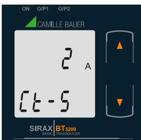
Mit der "➡ AB" Taste gelangen Sie in den "Neu / ändern CT Sekundärwert bearbeiten" Modus.
