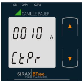
Mit der “**AB**” Taste gelangen Sie in den “Neu / ändern CT Primärwert bearbeiten” Modus.
