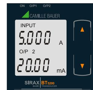
Anzeige 6: Strom- Eingang und Ausgang 2 als Strom
