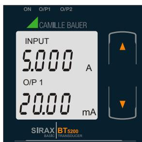
Anzeige 4: Strom- Eingang und Ausgang 1 als Strom
