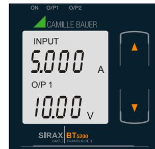
Anzeige 3: Strom- Eingang und Ausgang 1 als Spannung
