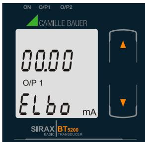
Mit der "➡ AB" Taste gelangen Sie in den "Neu/ändern Knickwert des Ausgangs 1 bearbeiten" Modus.
