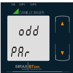
Mit der “**➔ AB**” Taste gelangen Sie zu dem “Parität & Stoppbit bearbeiten” Modus und zeigt folgende Werte:
