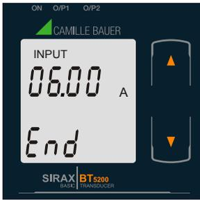
Mit der “**➤** AB” Taste gelangen Sie in den “Neu/ändern Eingangs-Endwert bearbeiten” Modus.
