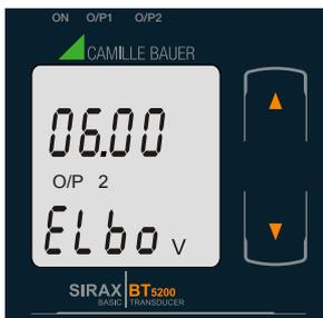
Mit der "AB" Taste gelangen Sie in den "Neu/ändern Knickwert des Ausgangs 2 bearbeiten" Modus.
