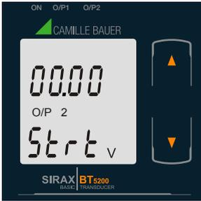
Mit der "AB" Taste gelangen Sie in den "Neu/ändern Startwert des Ausgangs 2 bearbeiten" Modus.
