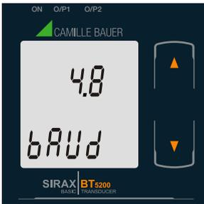
Diese Anzeige erlaubt dem Benutzer die Baud Rate Einstellung des RS 485 Port für dieses Gerät vorzunehmen. Die Werte die auf dem Bildschirm angezeigt werden, sind in kBaud.
