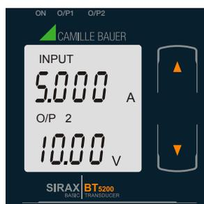
Anzeige 5: Strom- Eingang und Ausgang 2 als Spannung
