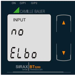
Drücken Sie die “**➔ AB**” Taste um in den “Knick-Funktion bearbeiten” Modus zu gelangen, um den Wert “yes” oder “no” einzustellen.
