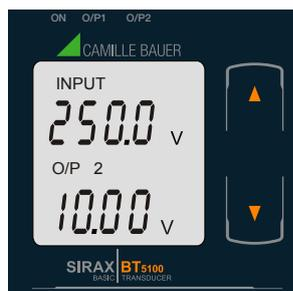
Anzeige 5: Spannungs- Eingang und Ausgang 2 als Spannung
