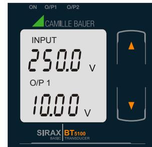
Anzeige 3: Spannungs- Eingang und Ausgang 1 als Spannung
