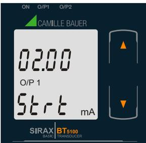
Mit der “**AB**” Taste gelangen Sie in den “Neu/ändern Startwert des Ausgangs 1 bearbeiten” Modus.
