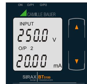
Anzeige 6: Spannungs- Eingang und Ausgang 2 als Strom
