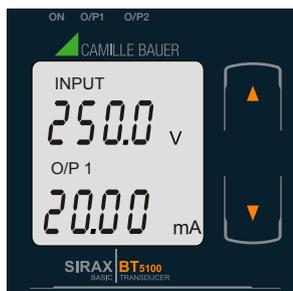
Anzeige 4: Spannungs- Eingang und Ausgang 1 als Strom
