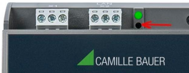
Falls die Kommunikationseinstellungen der Standard-Schnittstelle nicht mehr bekannt sind, können diese durch Drücken der versenkten Reset-Taste (unterhalb der Betriebs-LED) für mindestens 3s auf die Defaulteinstellungen zurückgesetzt werden. Während dem Reset blinkt die Betriebs-LED rot. Nach der Rücksetzung wird das Gerät neu gebootet.
