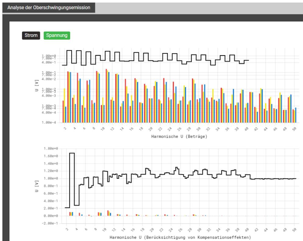
Die beiden Grafiken zeigen den Vergleich der **berechneten Spannungsüberschwingungen** mit den ermittelten Grenzwerten, unten mit Berücksichtigung eventueller Kompensationseffekte. In der unteren Grafik können die Grenzwerte variieren und pro Phase unterschiedlich sein, da sie basierend auf den aktuellen Oberschwingungsemissionen der Spannungen (ohne Hintergrundverzerrung) bestimmt werden.
