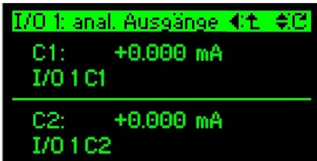
Für analoge Ausgangsmodule wird pro Kanal der Ausgangswert und der Kanaltext angezeigt.
