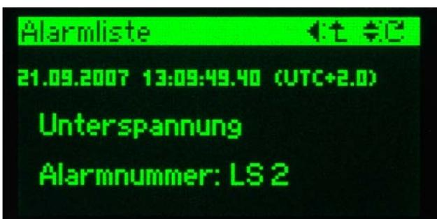
Über das Display sind alle Aufzeichnungen mit Zeitstempel und zugeordnetem Text abfragbar. Falls das Sicherheitssystem aktiviert war, ist für ausgewählte Anzeigen auch der involvierte Anwender verfügbar. Dadurch kann z.B. nachvollzogen werden, welcher Anwender einen Alarm quittiert hat.
