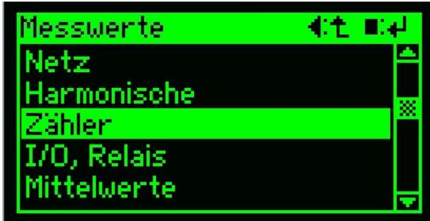
Zählerwerte werden sowohl für das gemessene Netz als auch für analoge Eingänge erfasst. Für digitale Eingänge erfolgt die Erfassung nur, falls sie als Zählereingang konfiguriert sind.
