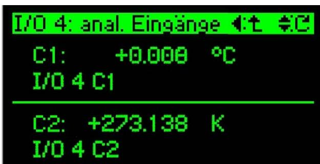
Für analoge Eingangsmodule wird pro Kanal der skalierte Messwert und der Kanaltext angezeigt.
