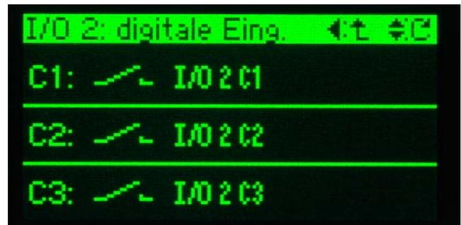
Für digitale Ein- oder Ausgangsmodule wird pro Kanal der Zustand und der Kanaltext angezeigt.
