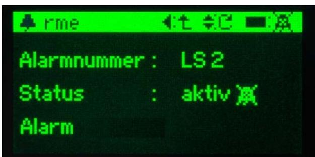
Durch die Quittierung wird eine eventuell definierte Aktion, z.B. das Schalten eines Relais-Ausgangs, zurückgesetzt.
