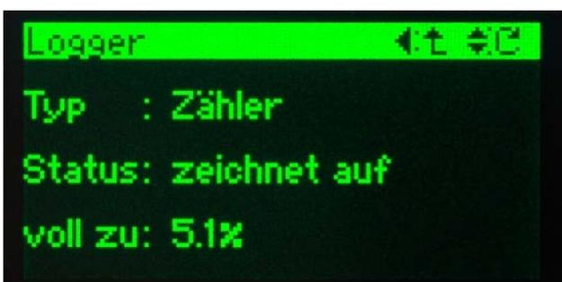
Über das Display kann der Status des Loggers abgefragt werden. Dadurch kann beurteilt werden, wie lange die entsprechende Datenaufzeichnung noch weiterlaufen kann. Bei Endlos-Aufzeichnung ist keine spezifische Zustands-Information verfügbar.
