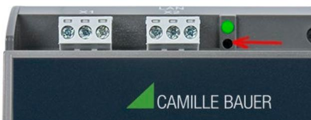
Falls die Kommunikationseinstellungen der Standard-Schnittstelle nicht mehr bekannt sind, können diese durch Drücken der versenkten Reset-Taste (unterhalb der Betriebs-LED) für mindestens 3s auf die Werkseinstellungen zurückgesetzt werden. Während dem Reset blinkt die Betriebs-LED rot. Nach der Rücksetzung wird das Gerät neu gebootet.
