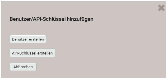
**Benutzer:** Während der Passwordeingabe werden die Anforderungen an ein sicheres Passwort überprüft und das Ergebnis angezeigt. Der Benutzer kann auf Basis der Rechte eines existierenden Benutzers erzeugt werden (im Beispiel ,admin'), diese Berechtigungen sind anschliessend noch änderbar.
