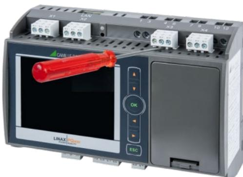
Um Zugang zu den Schraubanschlüssen der Stromeingänge zu erhalten, müssen eventuell darüber liegende Steckklemmen vorgängig entfernt werden.
