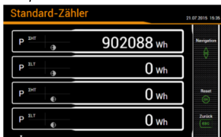
CU3000: Zähler mit Tarif- und Quadranten- Information
